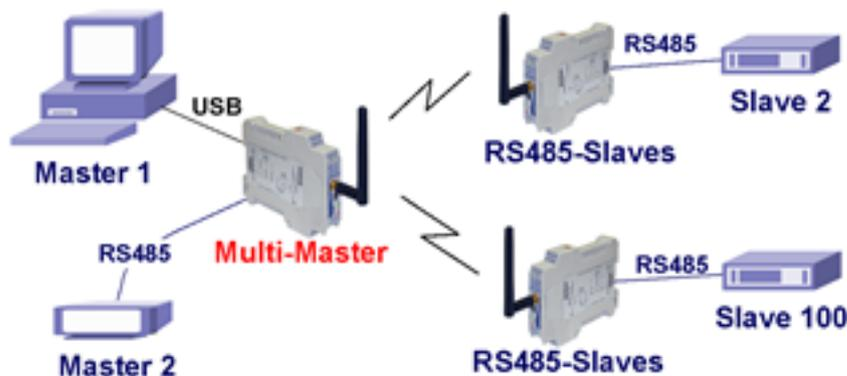
2. Se for utilizado um mestre Modbus na interface USB, deve-se utilizar o modo de operação USB-Master. Neste modo é possível utilizar a interface RS485 para conectar escravos na rede.
